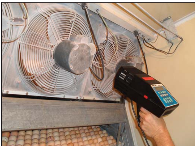
Obrázek 6: Používání stroboskopického světla ke kontrole rychlosti ventilátorů.
