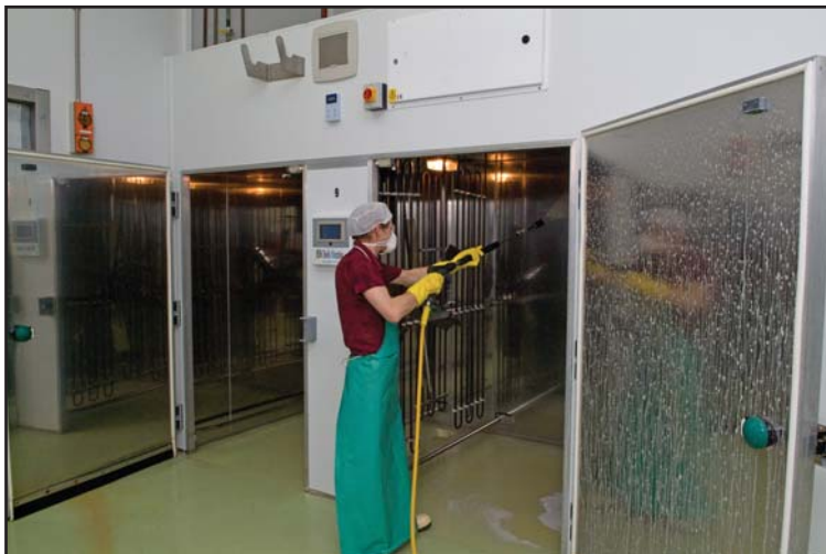
Obrázek 12: Použití nízkotlakého mycího systému k čištění dolíhně.
