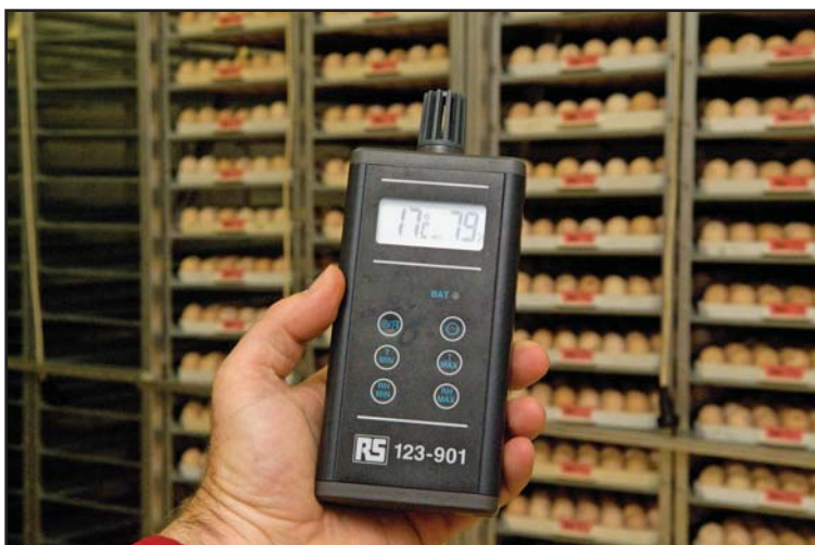
Obrázek 11: Kontrola prostředí pro skladování vajec pomocí snímače teploty a vlhkosti.
