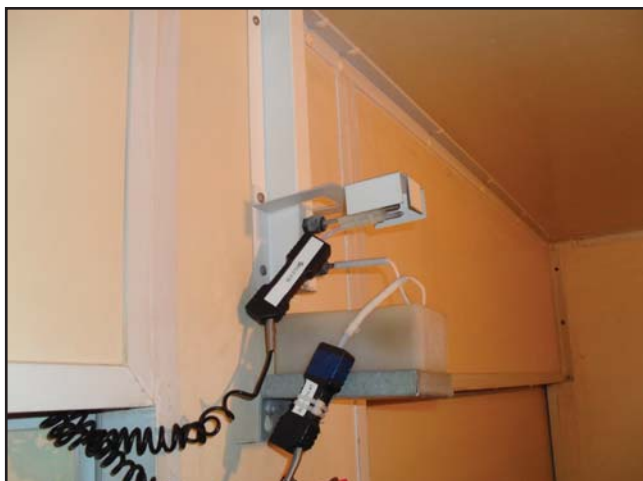
Obrázek 7: Kalibrace umístěním kalibrační sondy vedle teplotního snímače přístroje
