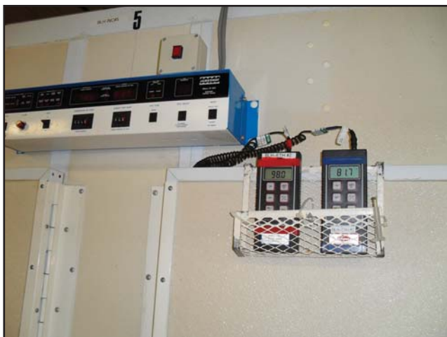
Obrázek 7: Kalibrace umístěním kalibrační sondy vedle teplotního snímače přístroje
