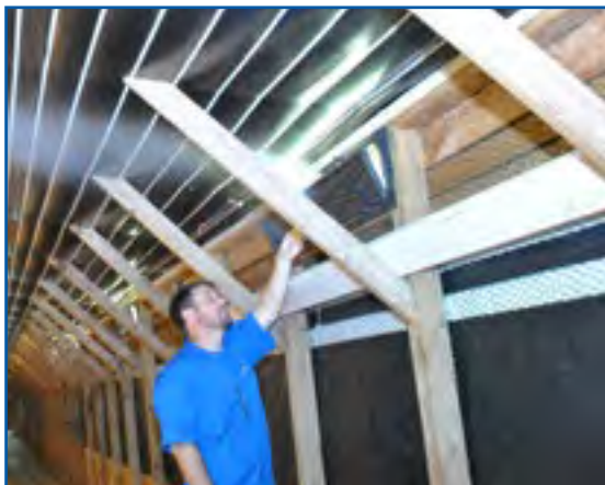
6.7 ábra: Füstteszt használata annak megállapítására, hogy a légáramlás és az üzemi nyomás megfelelő-e
