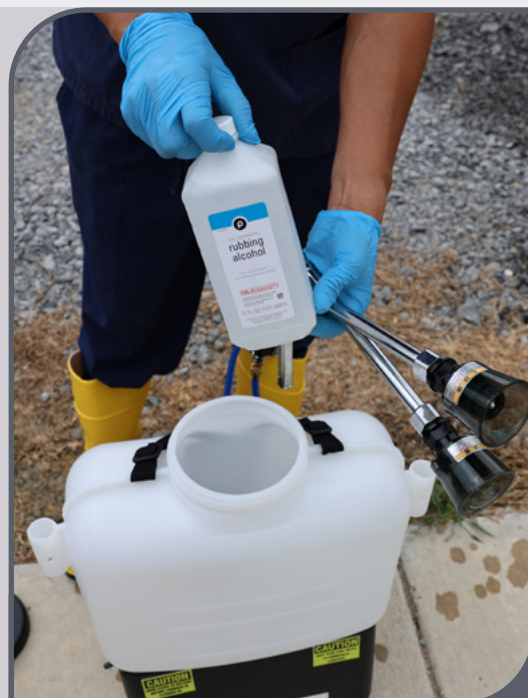
Disinfettare il serbatoio con alcol.
