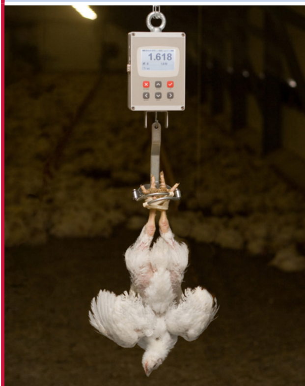
Figura 3.3 Pesagem individual de aves com uma balança eletrônica.
