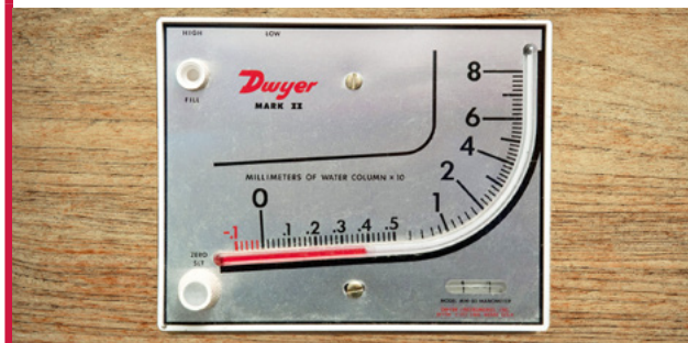
Figura 6.9 Um manômetro é usado para monitorar a pressão do ar dentro do galpão (a leitura fornecida é equivalente a 3,8 mm [0,15 pol.] de coluna de água [37,5 Pa]).
