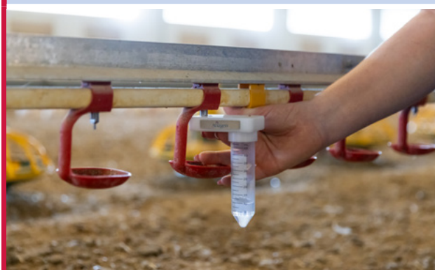
Figura 5.6 Medindo as taxas de fluxo da linha de bebedouro nipple.
