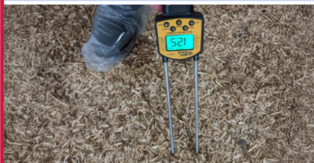
Figura 6.32 Medição da umidade da cama.
