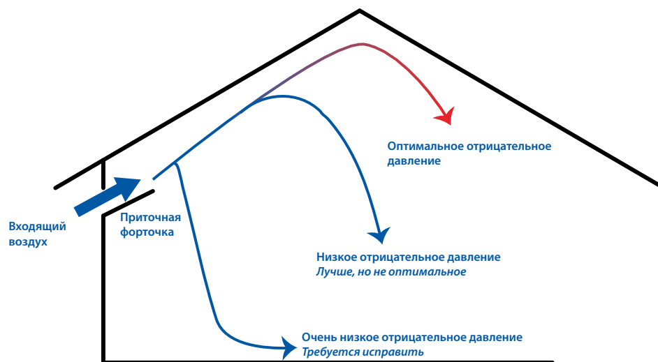
Рис. 6.5: Применение отрицательного давления для контроля скорости воздуха
